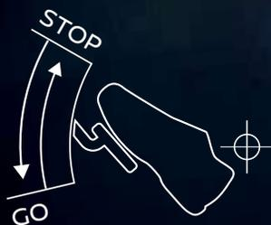
**e-Pedal.\*** Lorsque vous relâchez complètement la pédale d'accélérateur, la Nissan LEAF combine le freinage régénératif et hydraulique afin de s'arrêter avec souplesse et fluidité.
